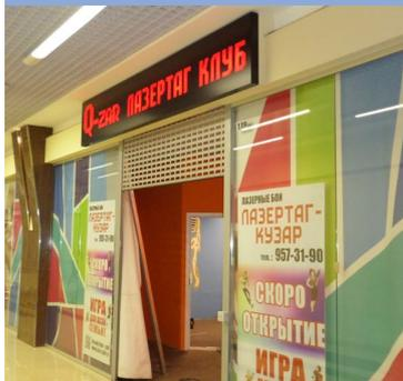
Используемые материалы: алюмокомпозитные панели, пластик, плёнка, для каркаса используется профильная трубы из металла, а так же спец. профильные системы. Оформление фасадов гибким неонем, сверхяркими светодиодами, с возможностью RGB (многоцветной) подсветки
